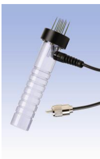
37-E/C , 8-Pins elektrode (38mm) met geïsoleerde pinnen voor garencoren
